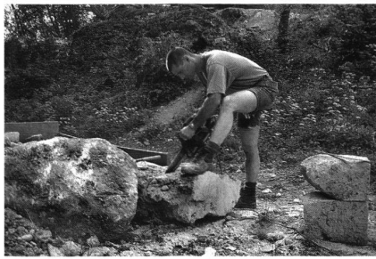
11: Zersägen von Tuffstein mit der Motorsäge.
