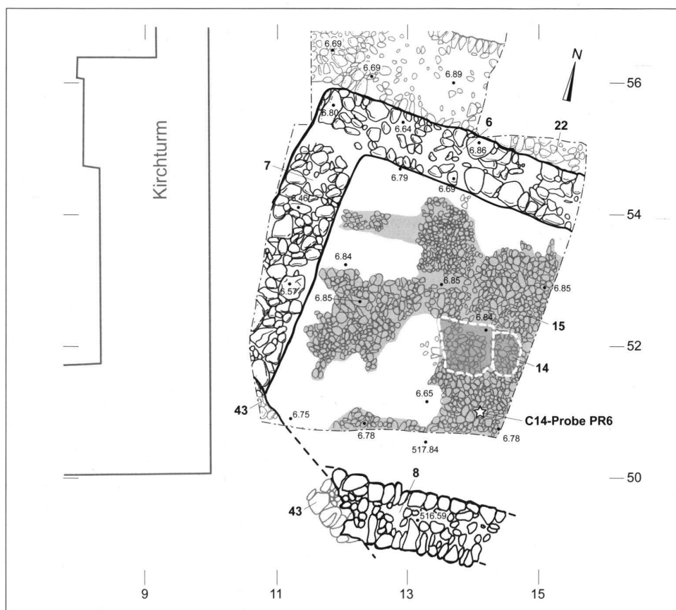
7: Grundrissplan der Kirche I. Stern: Lage der C 14 -Probe PR 6 unter dem Mörtelboden 15. Kirche I: 6–8 Aussenmauern, 14 Deckplatten des Grabes 1, 15 darüberliegender Mörtelboden mit Steinrollierung (erhaltene Ausdehnung der Mörtelschicht gerastert dargestellt); Kirche II: 22 Nordmauer; 43 neuzeitlicher Kanal.
