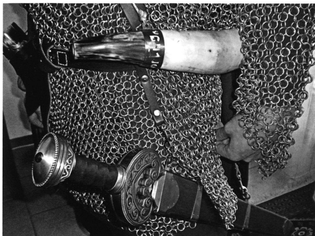
18: Die «Inspiration» für meine Maturaarbeit: mein Kettenhemd nach Helvetischer Technik. Länge des verarbeiteten Drahtes: ca. 556 m; Drahtstärke: 2 mm; Anzahl Ringe: ca. 13 900; Gewicht: 11,6 kg; Ring-Innendurchmesser: 11 mm. Arbeitsaufwand: während acht Monaten ca. 150 Stunden.
