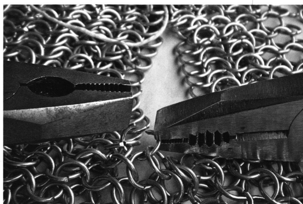
13: Die Ringe werden mit der Zange aufgebogen und nach dem Einhängen wieder zusammengebogen.
