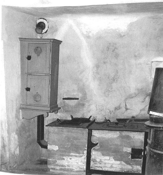
10: Schloss Reichenau. V.r.n.l.: Wasserbad mit der Feuerung seitlich rechts; Sandbad; zwei Trockenschränke, darüber der Eintritt des Abluftrohres in den Kamin. Höhe der Arbeitsflächen 71 cm.
