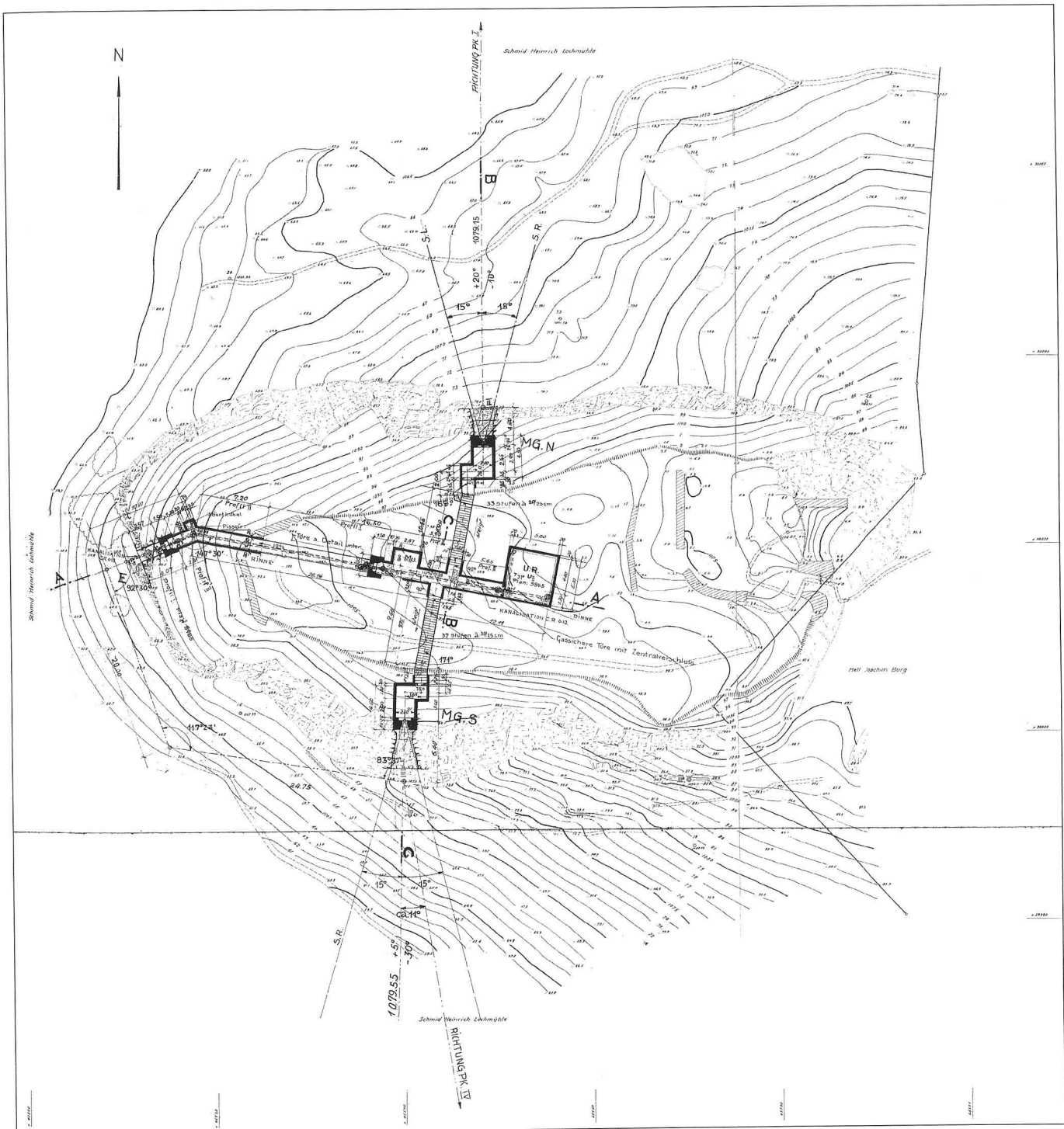
2: Wildhaus-Alt St. Johann SG, Wildenburg. Topografischer Plan des Burghügels aus dem Jahr 1939. Darin eingezeichnet sind die damals aufrecht stehenden Mauerzüge der Burgruine, unterlegt mit dem Grundriss des mit zwei Maschinengewehren bestückten Infanteriewerks.
