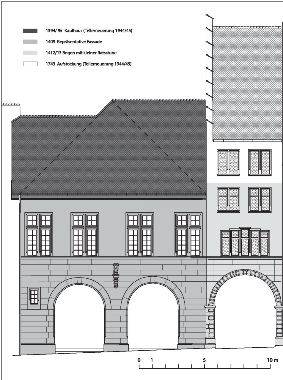
2: Ansicht Nordfassade von der Reichsstrasse (heute: Vordergasse) des Kauf- und Rathauses von 1394/95 mit der Erweiterung von 1412/13.
