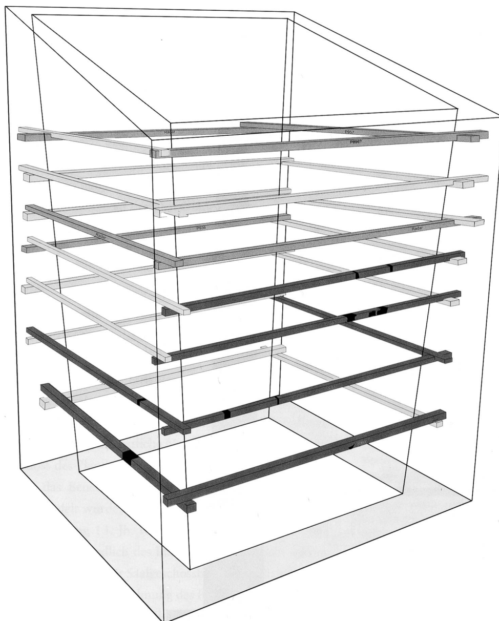
6: Münstair GR, Plantatum. Bestand der Ankerbalken im ottonischen Mauerwerk. Schwarz/dunkelgrau = Holz bzw. Negativ sicher nachgewiesen, grau = Hohlstelle durch Radarmessung und/oder archäologisch nachgewiesen, hellgrau = postulierte Ankerbalken.
