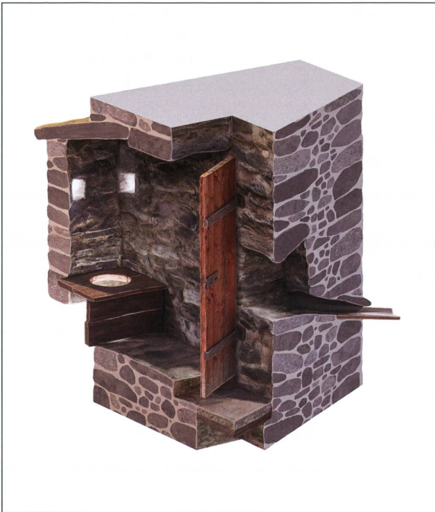
31: HOSPITAL UR, Turm 2021/22. Rekonstruktionsvorschlag Aborterker und Schüttloch.
