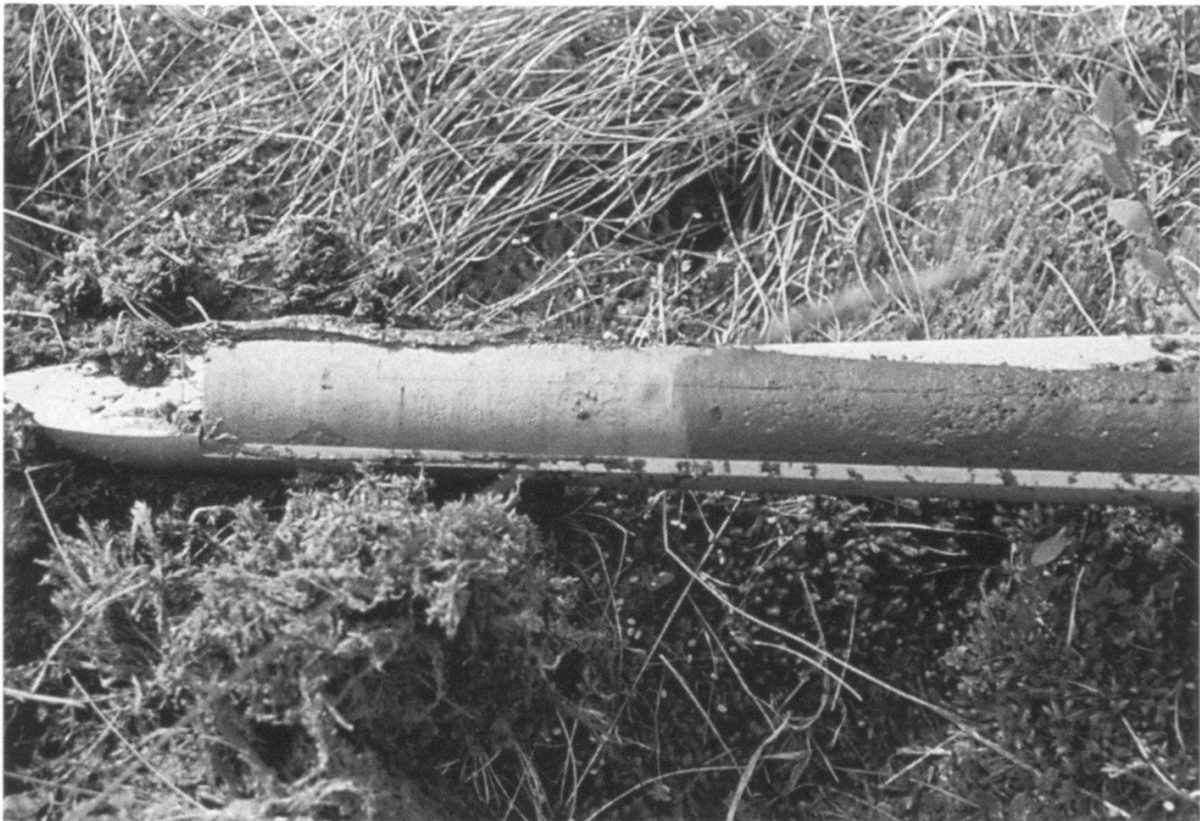
Abbildung 10: Dieser Bohrkern aus 2,50 m Tiefe zeigt den Übergang zwischen Flyschablagerung und gewachsenem Torf.
