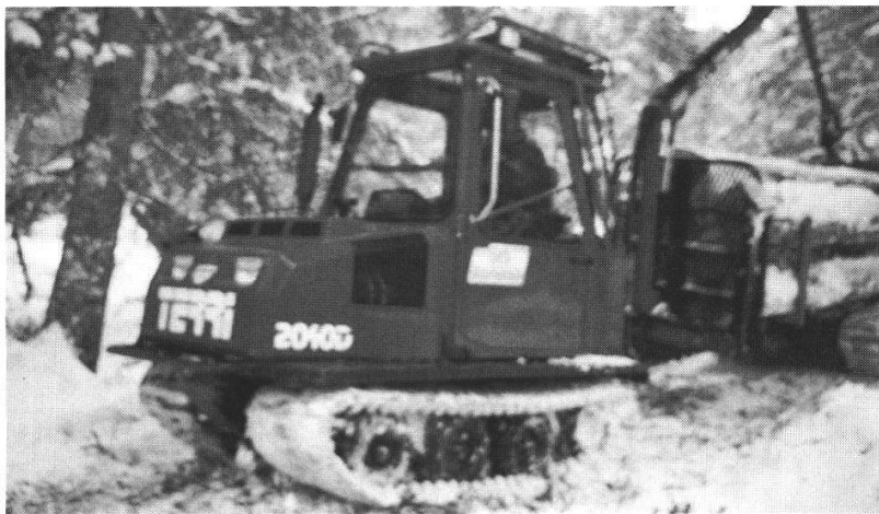
Abbildung 8: Kleinfahrzeug Terri 2020 D, welches sich im praktischen Test gut geeignet hat, mit Raupen, Hebekran und mit 3 m 3 Holz beladenem Raupenanhängler. (Foto R. Keller, November 1996)
