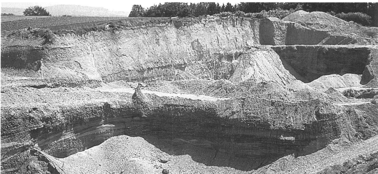
Abbildung 13: Kiesgrube Riederer bei Treiten ( Abb. 9, M31 ). Über einem gewaltigen Schotterkörper mit komplizierten Deltaschichtungen liegt eine mehrere Meter mächtige Moränenkappe. Die Abbruchwände ergeben zusammen eine Höhe von über 30 m. (Foto 1997)
