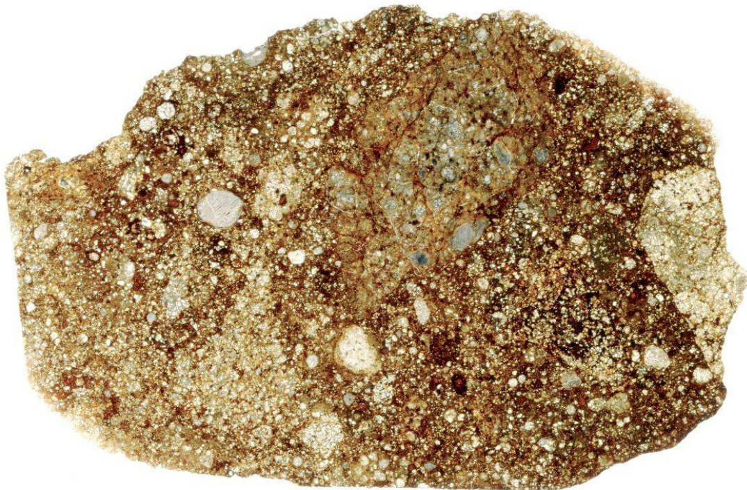
Abbildung 4: Dünnschliff eines Chondriten (Rumuruti-Typ) aus dem Oman. Dieser Meteorit zeigt sehr deutlich den Effekt vieler Impaktereignisse auf dem Herkunfts-Asteroiden. Das Gestein ist stark zertrümmert (brekziiert), Bruchstücke aus verschiedener Tiefe im Asteroiden (erkennbar an unterschiedlicher Rekristallisation), liegen nebeneinander. Daneben sind deutlich die kugelförmigen Chondren erkennbar. Breite des Dünnschliffes: 34 mm.
