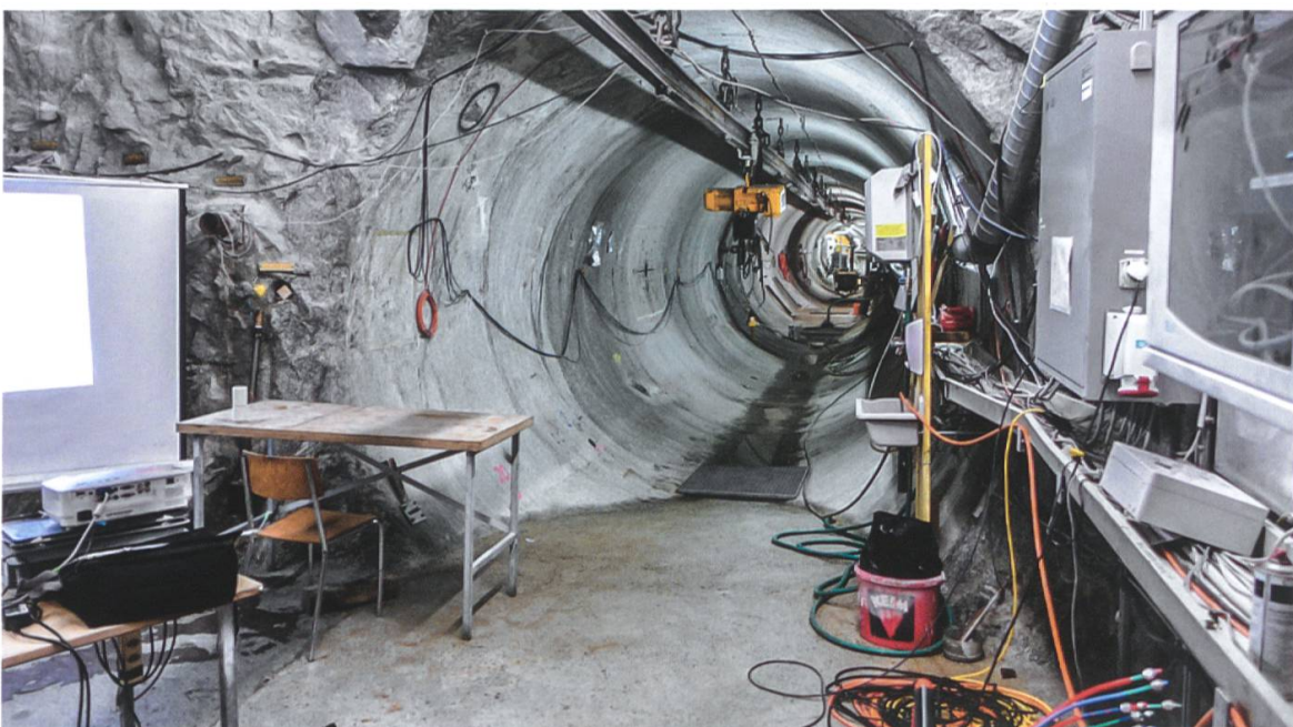
Abb. 6: Experiment zum stimulierten Aufbrechen des Kristallingesteins.
