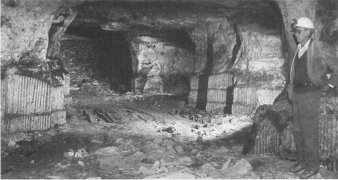
Abbildung 3: Die Mülhsteingrube "Bleiche-Waldshut" ist eigentlich eine riesige Halle mit stehengelassenen Tragpfeilern (Bergfesten). Deutlich sieht man im unteren Bereich die härtere Sandsteinbank mit den abgebohrten Mülhsteinrohlingen. Dieses Sedimentgestein lagerte sich im Unteren Trias (Buntsandstein) direkt auf dem Grundgebirge ab.
