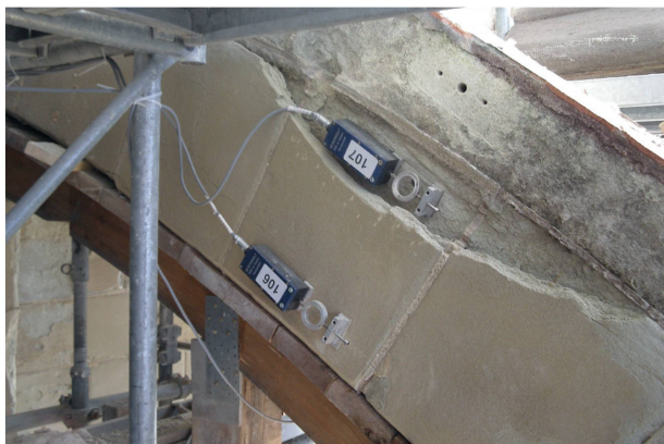
3 Mesures posés sur des arcs-boutants (Photo J.-P. Marmier).
