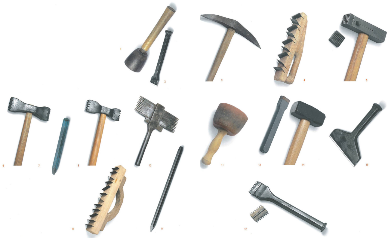
1 Les outils du tailleur de pierre (tiré de la Charte d'éthique et de bienfaisance pour la réfection de monuments et de bâtiments de l'Association romande des métiers de la pierre). Outillage à percussion lancée: pique (3); boucharde et plaquette (5); taillant bretté (6); taillant grain-d'orge (8); peigne (10). Outillage à percussion posée avec percuteur: ciseau (2); broche vidia (7); broche à pierre dure (9); gradine et plaquette (12); chasse (13); reparoir (15). Percuteurs: massette portugaise (1); maillet (11); massette (acier) (14). Outillage à percussion posée sans percuteur: rabot à dents (calcaire tendre) (4); rabot à molasse (16).
