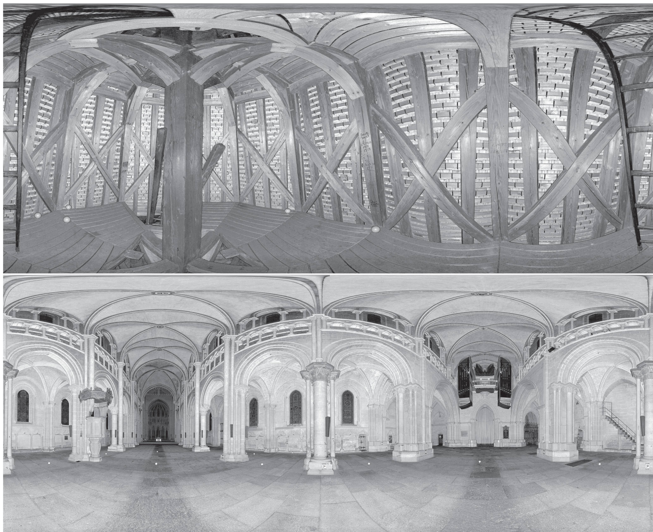
1 Pour chaque position du scanner, on obtient une vue panoramique à 360 degrés; tout ce qui se voit dans ces images est mesuré.
