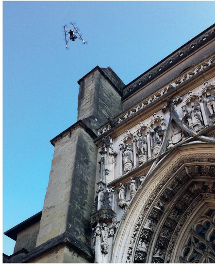
7 Le drone Asotec Falcon durant les prises de vue photogrammétriques du portail occidental. L'avantage du drone est la possibilité d'accéder de face à toutes les parties inaccessibles du sol.
