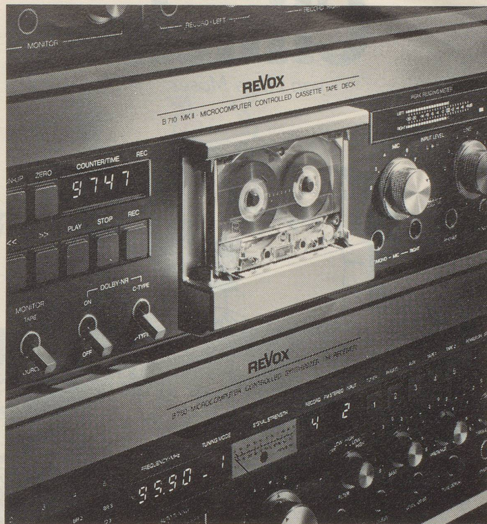
Das neue Revox Cassettendeck B710 MK II mit Dolby B und Dolby C.
