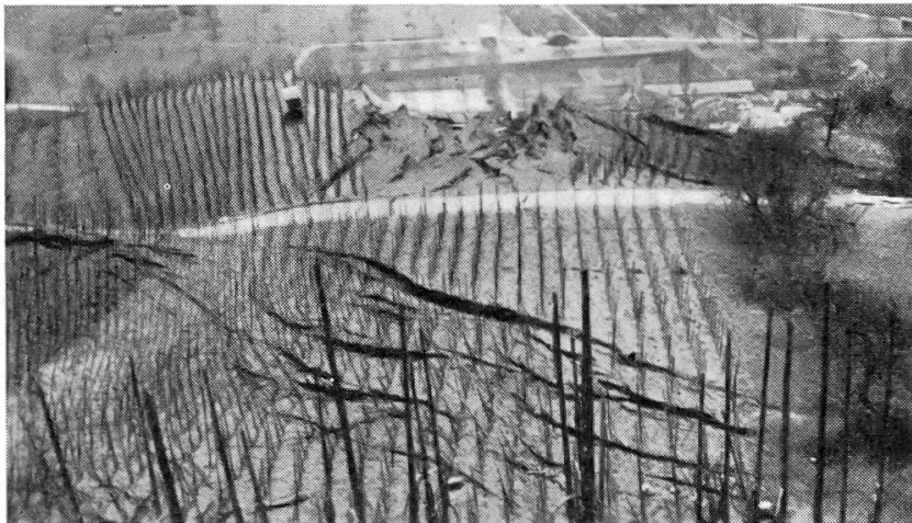
Abbildung 21. Obere Teilrutschung. Blick von Burghaldenstrasse auf Rutschung: Klaffende Spalten zwischen Abriss der oberen Teilrutschung und Hallenweg. Abgesun- kene Scholle oberhalb Grube mit in der Gleitrichtung verlaufenden Brüchen. Photo des Verf. 10. April 1952
