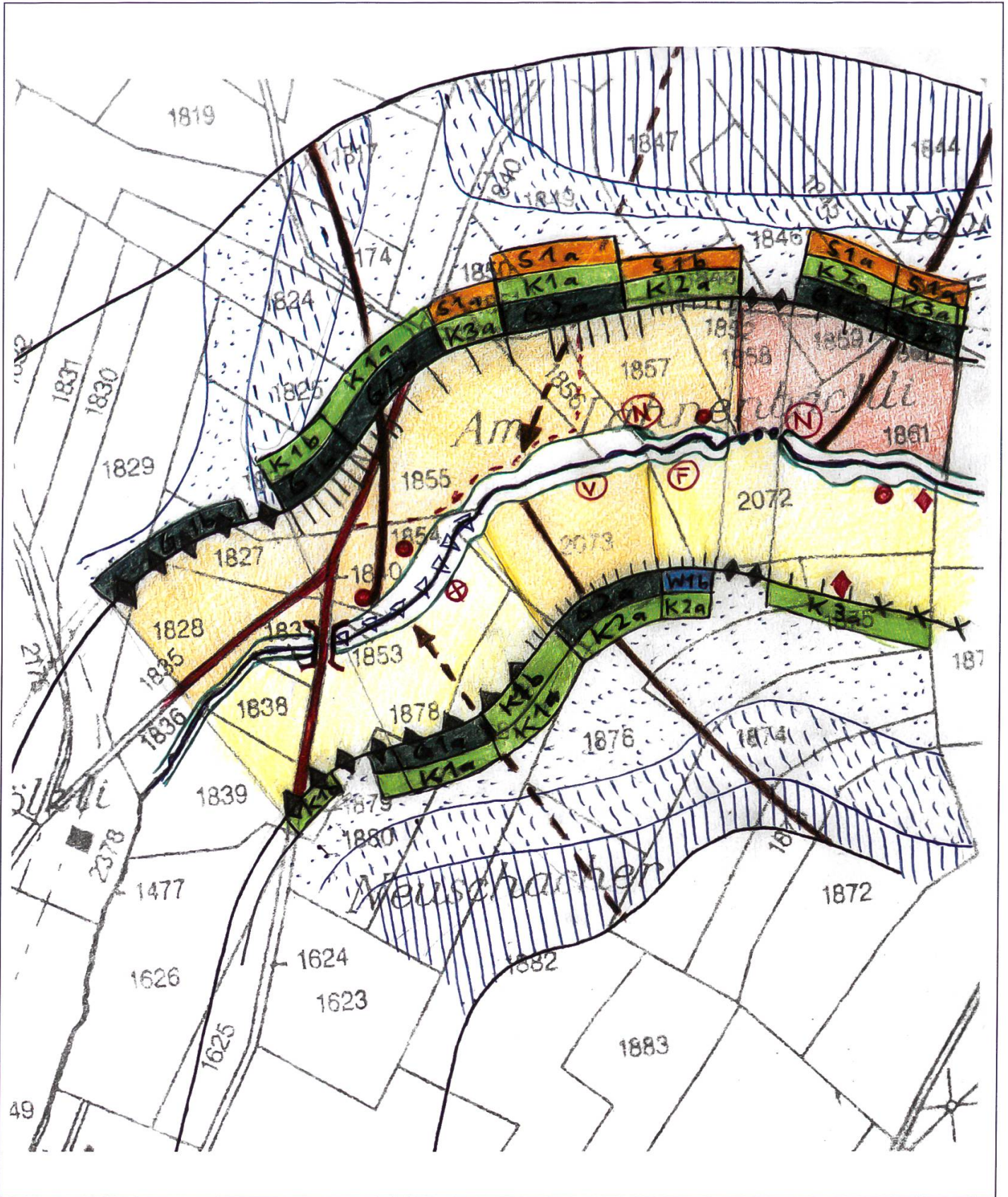
Abb. 4: Idealbeispiel einer geoökologischen Feldkartierung im Uferbereich: Die Kartierung im Gelände erfolgt auf einem Parzellenplan im Massstab 1:2500. Vor dem Kartiergang werden zwei Hilfslinien in circa 2 beziehungsweise 6 cm Abstand vom Vorfluter gezeichnet. Um die Massstabsproblematik bei der Kartierung auszuklammern, werden die Ufer-Vegetation-Strukturglieder und die Uferböschungen an der «inneren Hilfslinie» dargestellt. Die Hangneigung wird zwischen beiden Hilfslinien abgebildet. Ausserhalb dieser Hilfslinien wird nicht kartiert.
