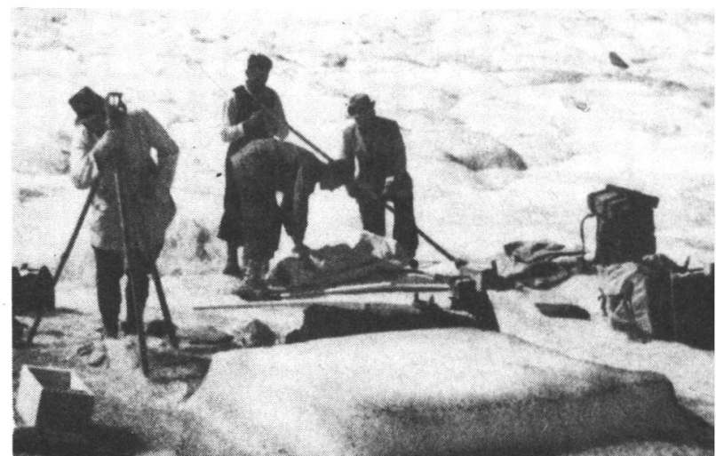
Als das Zelt nach vier heissen Julitagen abgebrochen wurde, kam ein Eissockel von 40 cm Höhe zum Vorschein. Auf der ungeschützten Eisfläche sind also 10 cm Eis im Tag weggeschmolzen! Unteraargletscher 1947
