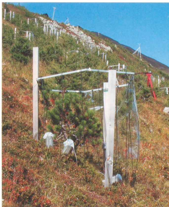
Abb. 2: Untersuchungsfläche für M. alpina am Stillberg bei Davos. Die Tiere wurden in den umgrenzten Parzellen in Gazebeuteln an Vaccinium gehalten. Sommer 2002. (Foto: T. Zumbrunn)
