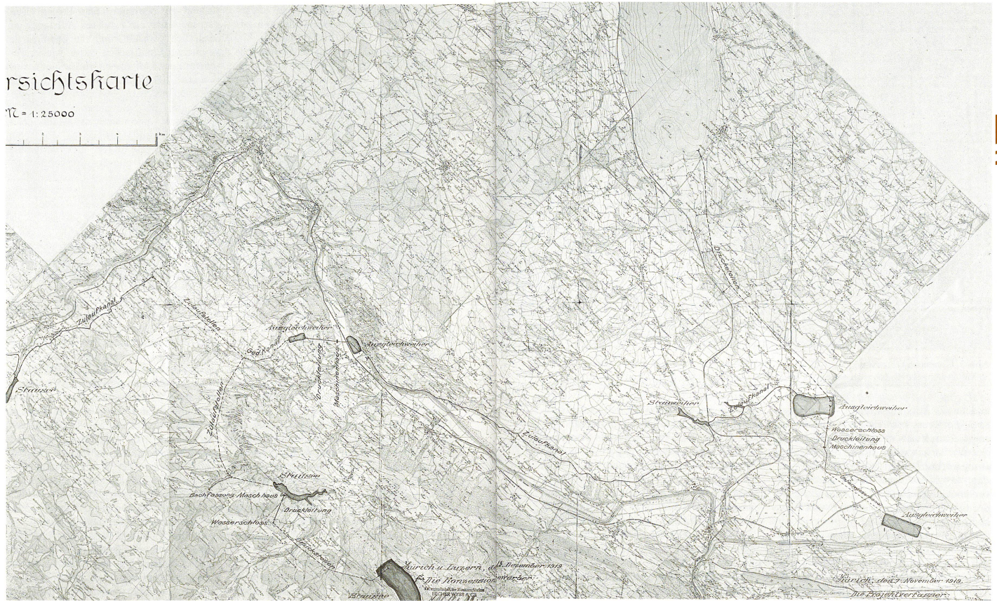
Abb. 2: Ausschnitt aus der Übersichtskarte zum Projekt «Waldemme – Sempachersee»: In Stollen sollte das Wasser von den Staustufen an der rechten Talflanke des Entlebachs zum Stausee bei
