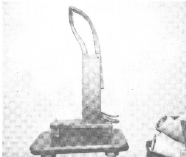
Mit diesem praktischen Nähkloben konnte der Sattler seine Materialien festhalten, damit er gut und fest nähen konnte.
