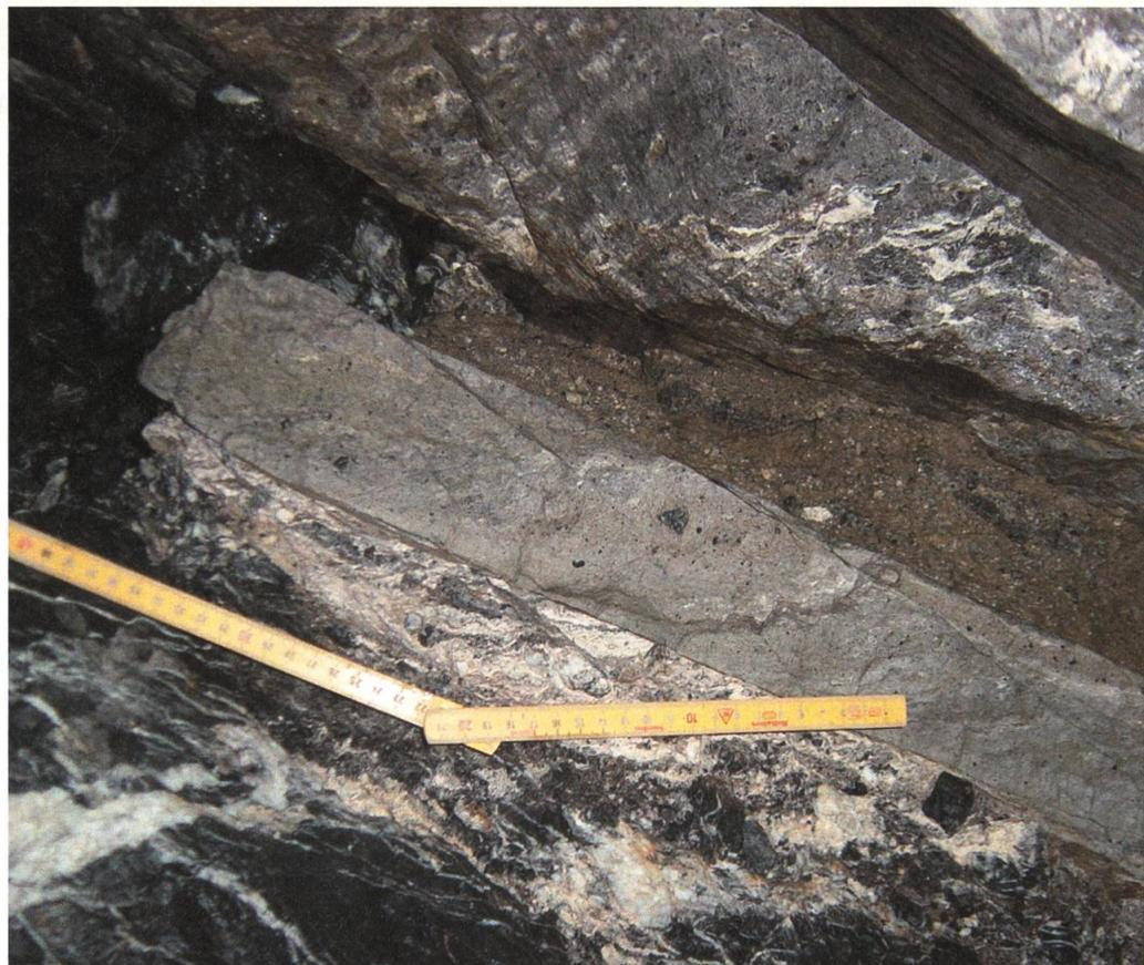
Detailansicht der Störzone, auf der die gesamte Tunnelklufthöhle angelegt ist. Die Störzone ist entstanden durch das Talwärtsgleiten der oberen Felsmasse über die untere. Das zwischen den Felsmassen liegende Gestein wurde zum Teil zu Mehl zerrieben.
