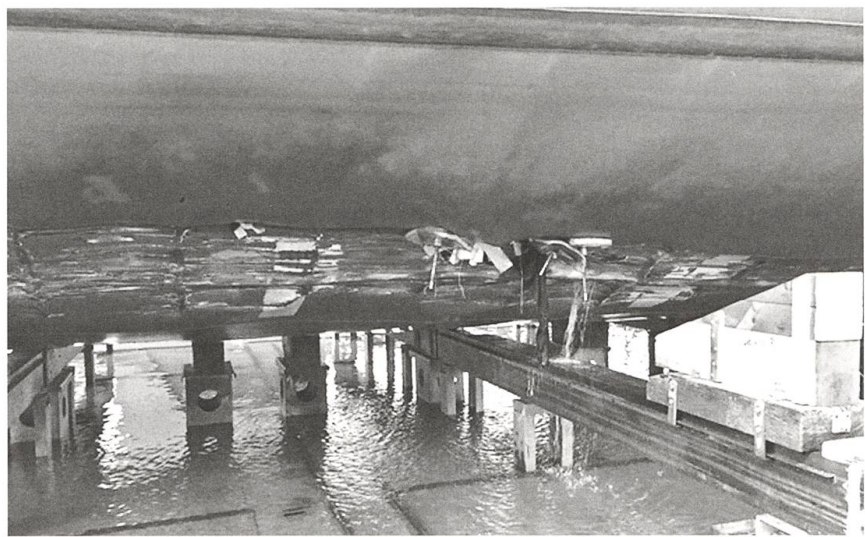
7.12. Blick auf den beschädigten Rumpf des Motorschiffes Diamant.
