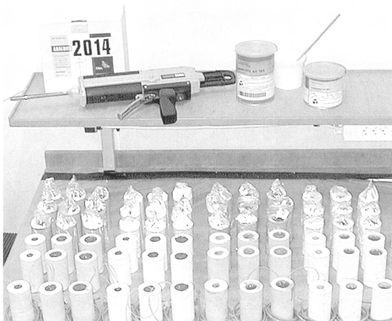
Expoxyd-Naturstein. Probenkörper mit Thermoelementen
