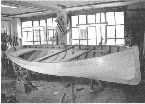
Barcarolle , réplique d'un canot de plaisance dessiné par l'architecte Jules de Catus, en construction au chantier naval Mayerat, à Rolle. Ce chantier traditionnel a construit ces dernières années plusieurs embarcations de ce type (Photo M. Pernet, Rolle).
