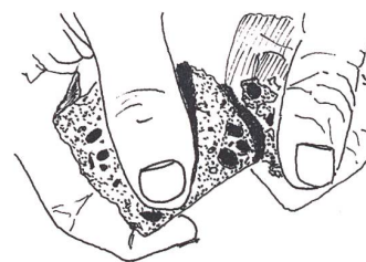
Mit der so genannten Fingerprobe lässt sich etwa die Festigkeit des Mörtels prüfen.
