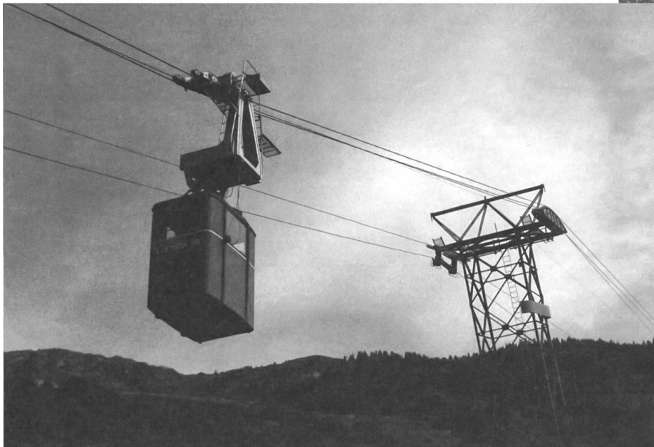
Kraftwerksbahn Rischinen – Massa, Bitsch (VS), von Küpfer (1961). Fahrzeug mit Personenkabine; im Hintergrund Stahl-Fachwerkstütze mit asymmetrischen Stützenköpfen.
