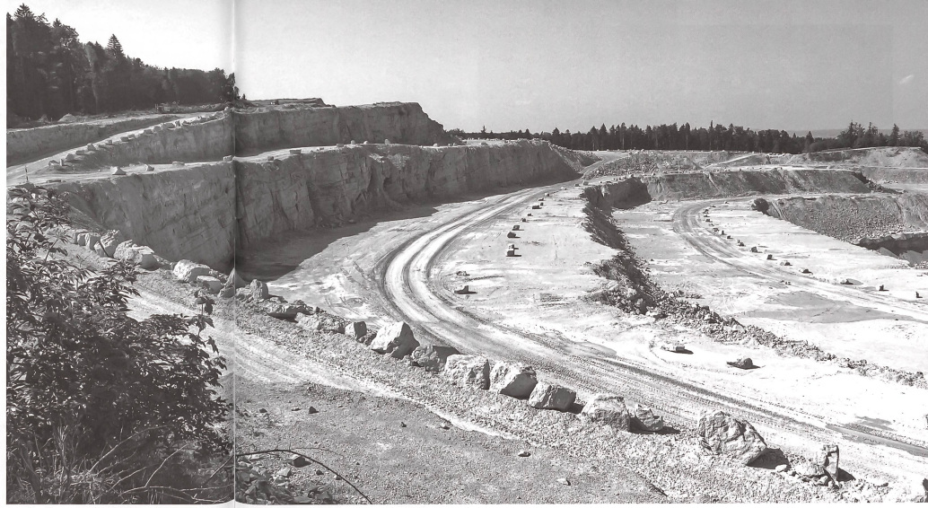
Steinbruch Gabenchopf bei Villigen (AG). Jurakalk wird hier für die Herstellung von Portlandzement abgebaut. Es ist ein aktiver, grossräumiger Abbau, der dank seiner geschützten Lage im Landschaftsbild jedoch kaum wahrgenommen wird.
