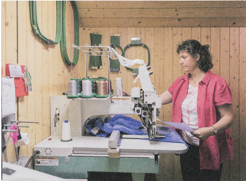
Abb. 7: Monika Schafflützel (*1967) arbeitet an der computergesteuerten Mehrkopfstickmaschine. Mit dieser Maschine ist es möglich, dreidimensional erscheinende Motive, z. B. das Profil eines Traktorpneus, zu sticken.
