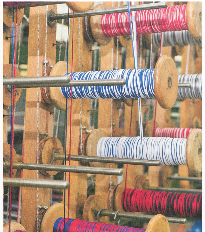
▶ Spulen mit bunten Kettfäden versorgen einen rund 140-jährigen Webstuhl aus der früheren Heimindustrie mit Garn.
