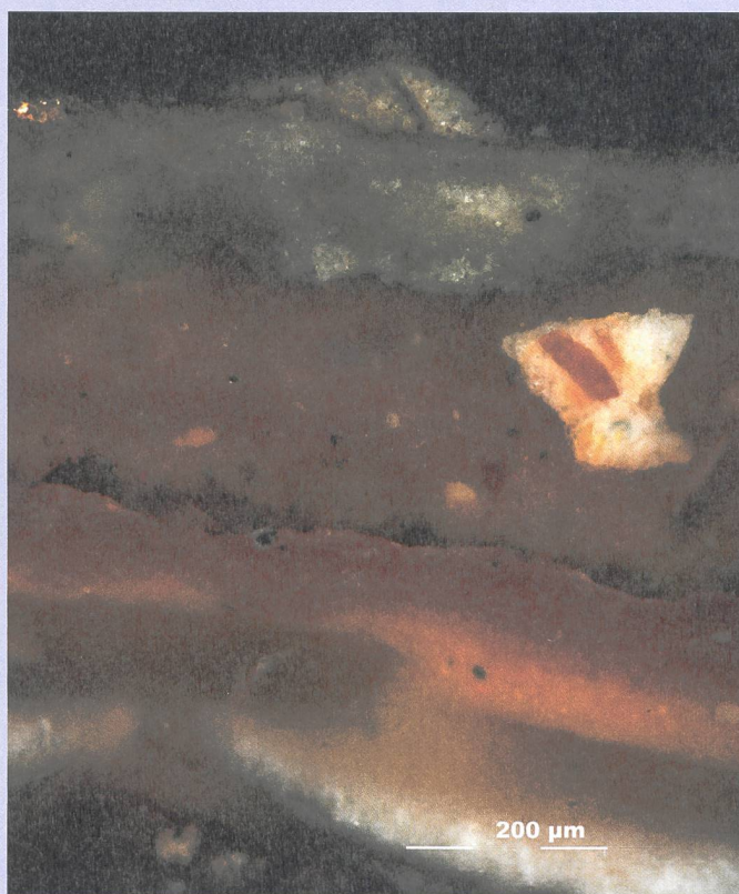
Anschliff der Probe D2 (Vergoldungen) unter 200-facher Sehfeldvergrößerung, Hellfeld, gekreuzte Polarisatoren. In der unteren Bildhälfte erkennt man die mehrschichtige Polimentvergoldung (Goldblatt horizontal in der Bildmitte). Darüber befindet sich eine Schicht grobkörnigen Poliments.
