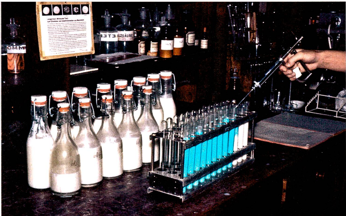
Milchanalytik: Methylenblautest im Labor an der Rosengasse (60iger Jahre). Foto: Kantonales Labor
