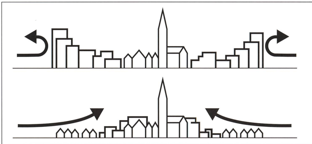
Abb. 11: Einfluss der randlichen Bebauung auf die Frischluftzufuhr von Stadtzentren (Quelle: C.L. Krause, 2006)
