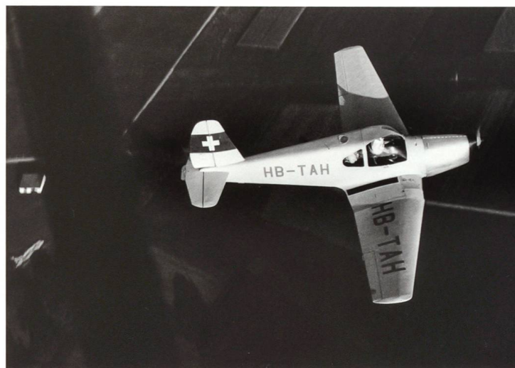
Die Sokol MID war das erste Flugzeug auf dem Gheid mit Einziehfahrwerk (Handkurbel)
