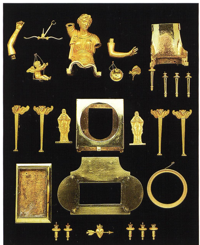
Oben: Eine frühe, echt vergoldete Kaminuhr Unten: Aus so vielen Einzelteilen besteht das Gehäuse der oben abgebildeten Kaminuhr.
