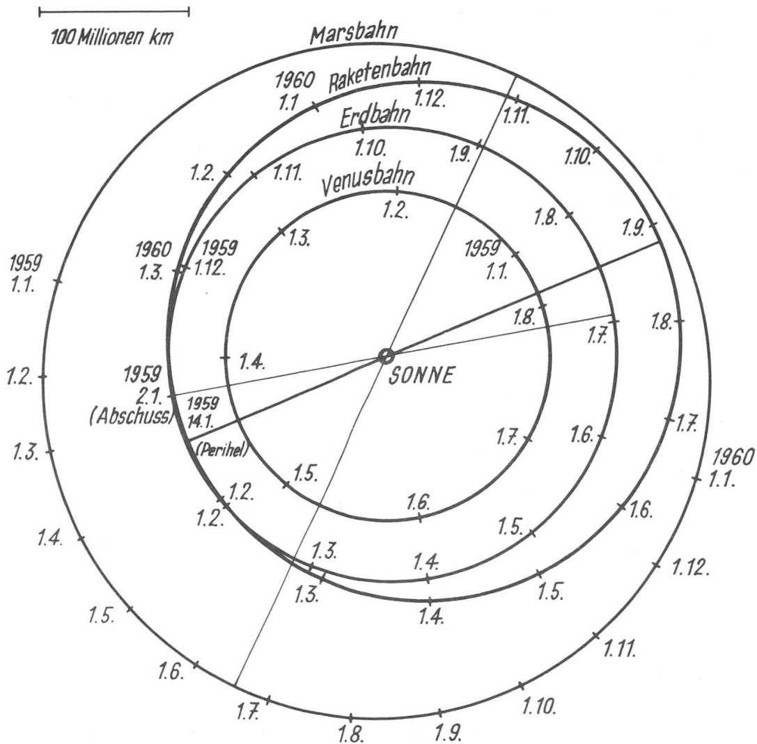
Die Bahn des künstlichen Planetoiden (bezeichnet als Raketbahn) liegt grösstenteils zwischen der Erd- und Marsbahn. Nur in der Nähe des Perihels liegt ein kurzes Stück der Bahn innerhalb der Erdbahn.
