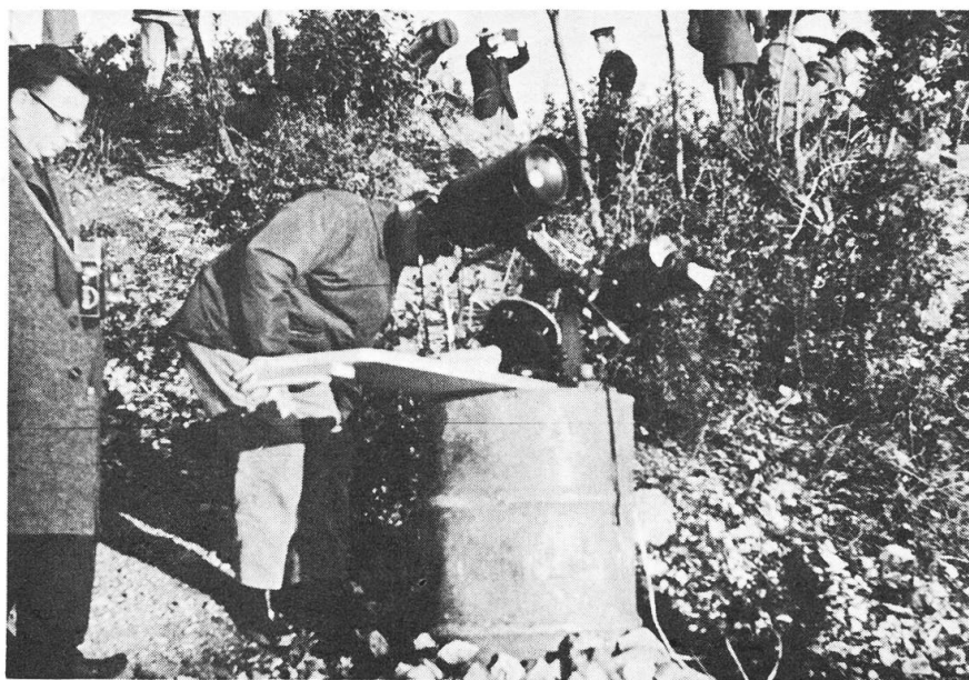
Figure 4 - Au Monte Cónero: l'installation de M. Ducrey, de Genève. (Télescope Maksutov-Cassegrain, diamètre 15 cm, longueur focale: 220 cm, monture équatoriale avec moteur synchrone. (Photo: E. Antonini.)
