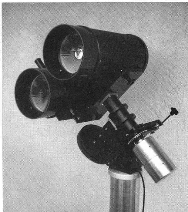
MAKSUTOW-Doppel-Teleskop 200/500 mm und 3200 mm
