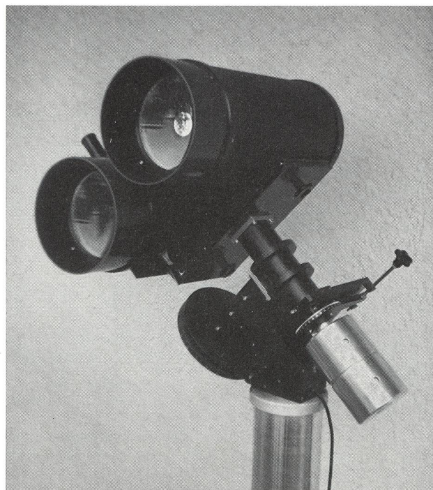
MAKSUTOW-Doppel-Teleskop 200/500 mm und 3200 mm
