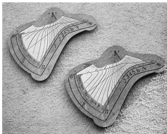
Abb. 1: Zifferblatt-Paar einer Sonnenuhr für MEZ an einer nach SW gerichteten Hausfassade an der Toggenburger Hauptstrasse in Neu St. Johann. Die Zifferblätter bestehen aus zwei Eternitplatten, in welche die Zeitlinien eingeschliffen wurden.
