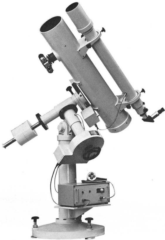
Fig. 3: Beispiel eines astrofotografischen NEWTON-Teleskopes 150 mm Diameter, bei dem u. a. die in dieser Mitteilung angegebenen Voraussetzungen erfüllt sind. (Bauart E. ALT).
