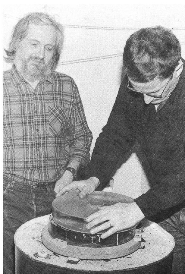
Fig. 2: Polissage d'un miroir de 30 cm. MM. V. FRYDER (à g.) et R. DURUSSEL.
