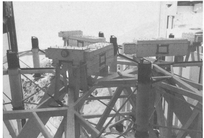
Abb. 7: Blick auf das Vorderende des MMT mit den 3 Periskopen und 5 der 6 Sekundärspiegelhalter. In der Mitte unten ist teilweise der Hauptspiegel des Nachführinstrumentes zu sehen, oben der dazugehörige Sekundärspiegelhalter.
