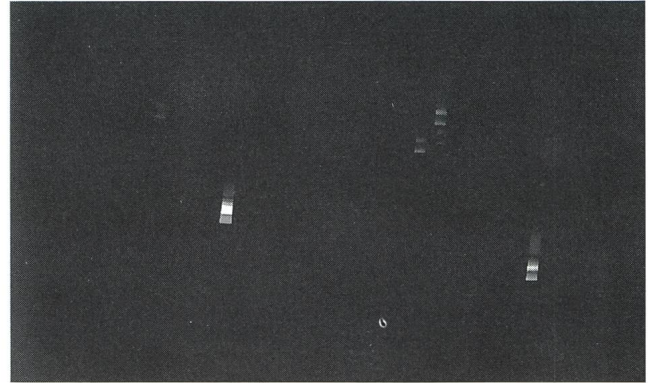
▲ 5. Hier wurde mit einem 300 mm-Teleobjektiv (1:4) durch ein 30°-Flintprisma hindurch photographiert. Es entstehen hübsche Sternspektren (am hellsten Beteigeuze, schwächer Bellatrix), an denen einige Absorptionslinien erkennbar werden und eine grobe Spektralklassifikation ermöglichen. Die Erddrotation wurde zur seitlichen Aufweitung der fadenförmigen Spektren verwendet, d.h. die Aufnahme wurde absichtlich nicht nachgeführt (Kodachrome 200).
