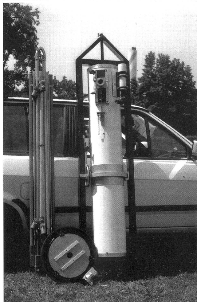
Bild 3: Demontierte Tetraedermontierung. Ersichtlich sind die im U-Profil zum Transport versorgten Rohrstützen, Rahmen mit Rohr und Antriebseinheit.
