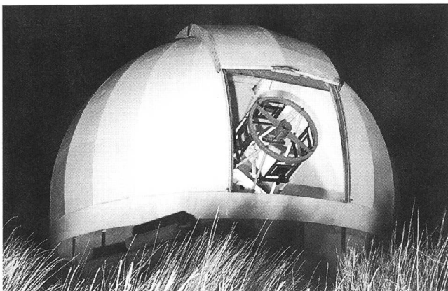
Das 106-cm-Teleskop schaut durch den Spalt der 6m-Kuppel. Nächtliche Blitzlichtaufnahme.
