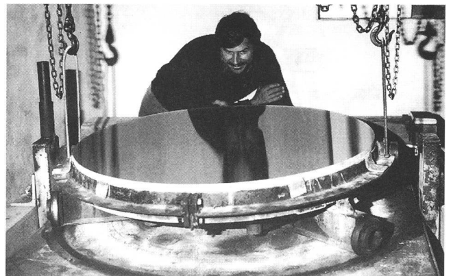
Dany begutachtet die Politur seines neuen 106cm-Zerodurspiegels.
