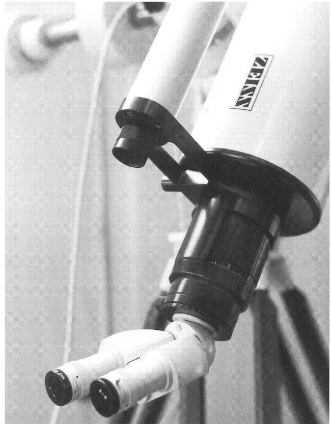
Figur 3: Das hintere Ende des Tubus mit dem Fokussiertubus sowie dem Zeiss-Binokularansatz und dem verstellbaren Sucher.
